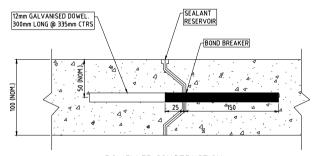
DOWELLED CONSTRUCTION (CONNOLLY) JOINT - UNREINFORCED
